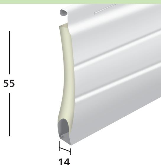
Avvolgibile in alluminio coibentato con poliuretano espanso ecologico tipo "ECO", con tappi laterali antiscorrimento, peso circa Kg 3 al mq, vernice base colorata 16 micron senza trasparente.
