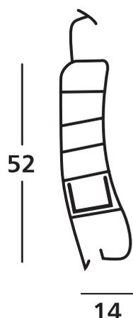
Avvolgibile in pvc con fermi antiscorrimento a sagoma curva tipo "EXTRA", peso Kg 5 al mq. Massimo impiego consigliato con ferri di rinforzo ml 2,30.
