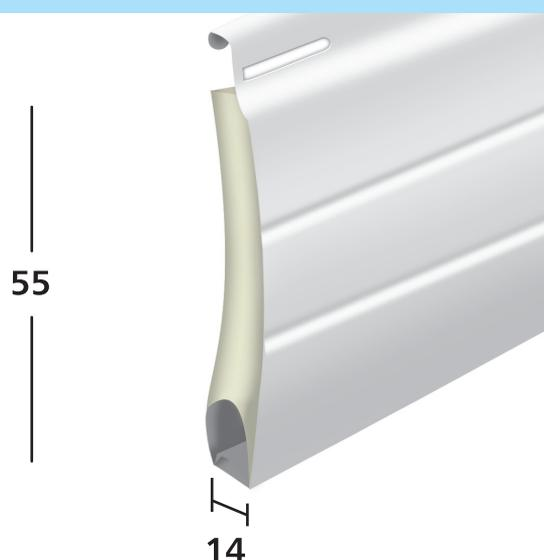
Avvolgibile in acciaio coibentato con poliuretano espanso ecologico tipo "CONFORT", con tappi laterali antiscorrimento, peso circa Kg 10 al mq, Massimo impiego consigliato ml 4,5.
