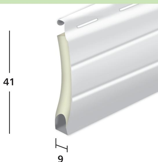
Avvolgibile in alluminio coibentato con poliuretano espanso ecologico tipo "MINI", con tappi laterali antiscorrimento, peso circa Kg 3,20 al mq, vernice base colorata 16 micron più trasparente 16 micron. Massimo impiego consigliato ml 3.
