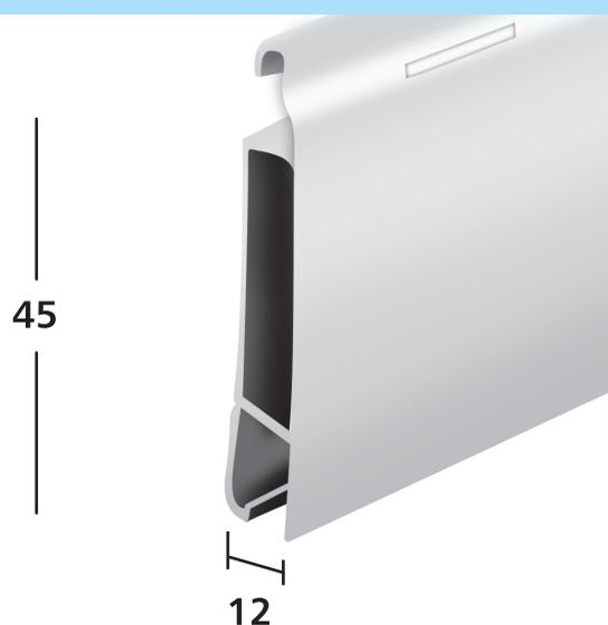
Avvolgibile in alluminio estruso tipo "MAXI", con tappi laterali antiscorrimento, peso circa Kg 8 al mq. Massimo impiego consigliato ml 4,5.
