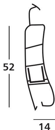
Avvolgibile in pvc con fermi antiscorrimento a sagoma curva tipo "STANDARD", peso Kg.4,5 al mq. Massimo impiego consigliato con ferri di rinforzo ml 2,30.
