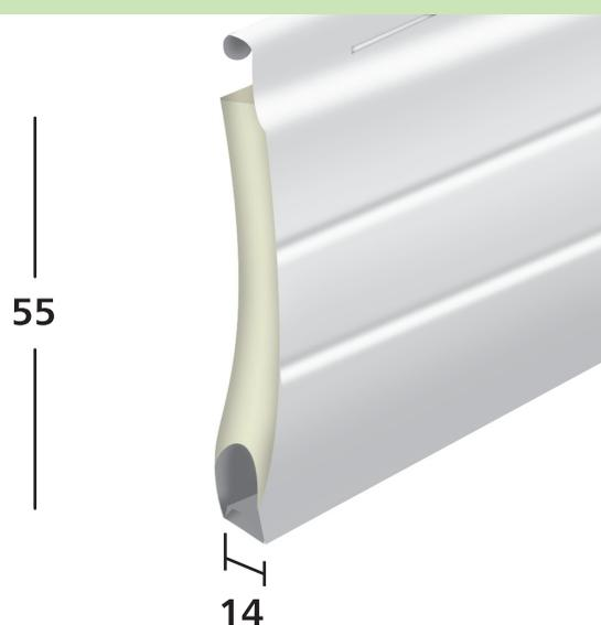
Avvolgibile in alluminio coibentato con poliuretano espanso ecologico tipo "CONFORT", con tappi laterali antiscorrimento, peso circa Kg 3,70 al mq, vernice base colorata 16 micron più trasparente 16 micron.
