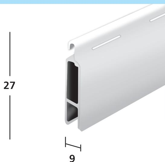
Avvolgibile in alluminio estruso tipo "MINI", con tappi laterali antiscorrimento, peso circa Kg 9 al mq. Massimo impiego consigliato ml 4,5.
