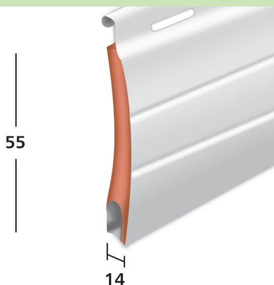
Avvolgibile in alluminio coibentato con poliuretano espanso ecologico tipo "ALTA DENSITÀ", con tappi laterali antiscorrimento, peso circa Kg 5,10 al mq, vernice base colorata 16 micron più trasparente 16 micron.
